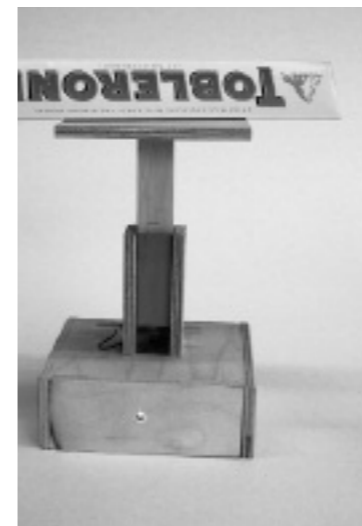
Magnetische Briefwaage mit Gewichtsanzeige: Zwei Supermagnete stossen sich ab. Sobald eine Brief mit mehr als 100 g gewogen wird, leuchtet die Diode.
